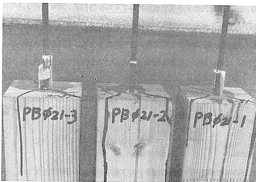
PCネジの破壊状況 ネジ径 \phi 10mm 孔径が \phi 21mmの場合
