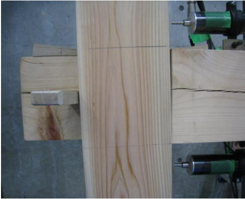
鼻-B-30hh(J-4-①hh4)ほぞせん断破壊(1/8. 8rad)
