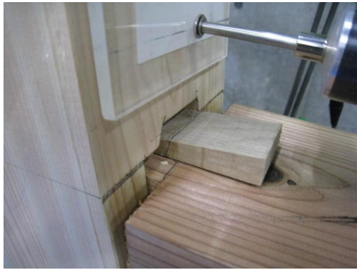
鼻-B-36hs(J-4-②hs3)柱-梁ずれ(1/8. 8rad)
